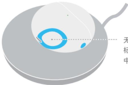
无线充电线圈位于充电盒华为品牌标识一侧。充电时，请将充电线圈中心与无线充电器中心对齐放置。
